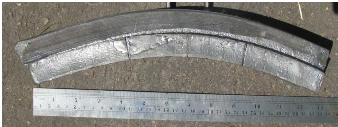
Рис. 2 . Исследуемый образец № 2 после прокатки
